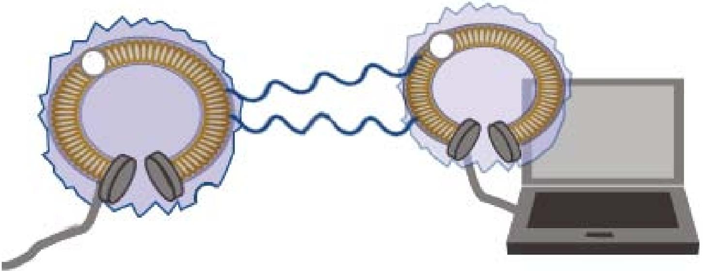
Actualmente existen diversos prototipos para lograr telealimentación de sistemas eléctricos. La idea básica es transmitir energía por vías inalámbricas. La Universidad Europea de Madrid produjo un primer sistema básico que permite alimentar equipos a corta distancia (unos 10 metros), suministrando una potencia de hasta 400 milivatios (mW).
