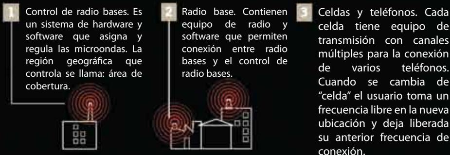
**1** Control de radio bases. Es un sistema de hardware y software que asigna y regula las microondas. La región geográfica que controla se llama: área de cobertura.
